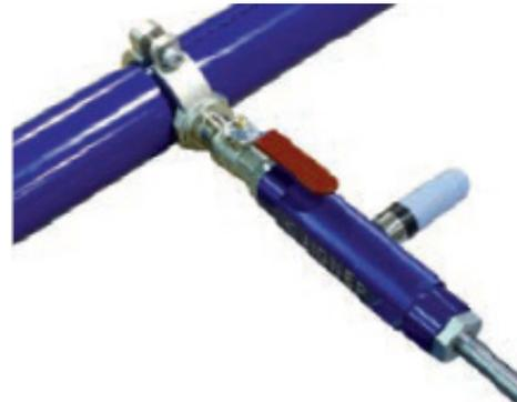
3. Den Bohrer auf das Bohrwerkzeug 90252 montieren und das Rohr bis zum Anschlag aufbohren.
