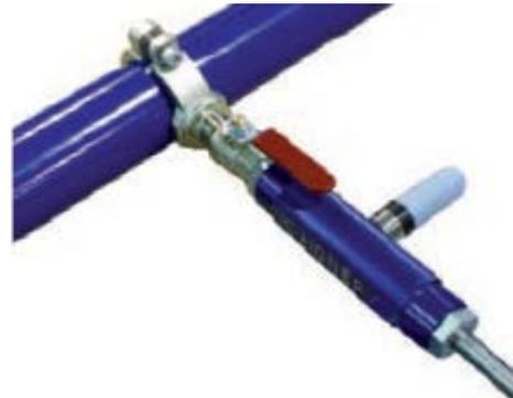
3. Montar a broca na ferramenta de perfuração 90252 e perfurar o tubo até ao batente.
